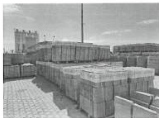
Fig.17 Imagine cu modul de depozitare al corpurilor de rigole carosabile.
