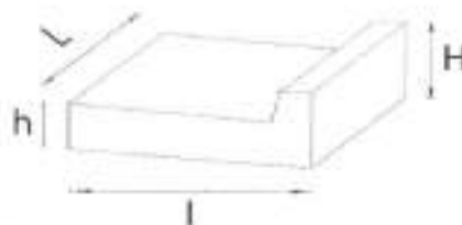
Fig. 8 Corp de rigolă de acostament
